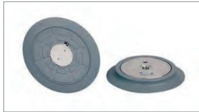
BCS-AE 系列带特殊衬垫结构： 搬运金属薄板(厚约1.0-2.5 mm)，可克服薄板之间的自粘附力。
