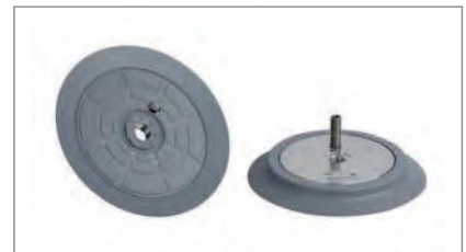
BCS-TV 带有感应阀： 能够感应并关闭没有接触工件的真空吸盘(大型多吸盘工具)，防止空气进入
