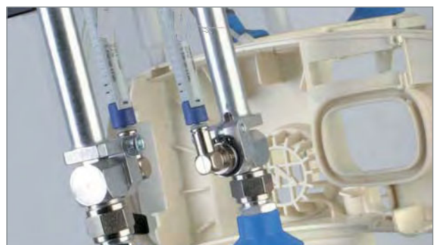
线型真空发生器DZU应用于塑料注塑成型部件搬运作业中
